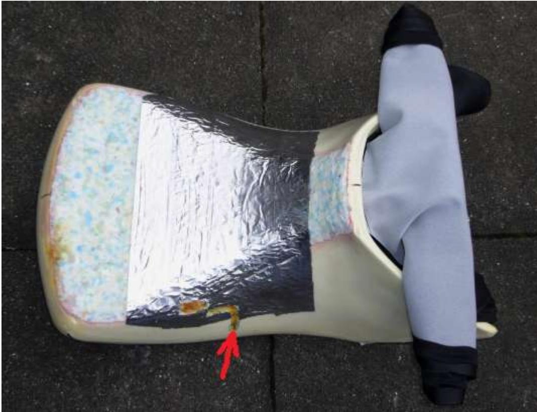
Stage 2: ...und das sieht dann so aus. Am Ende des Brandmals (Pfeil) wird der 8mm Durchlass für das Anschlußkabel der Heizmatte gebohrt.
