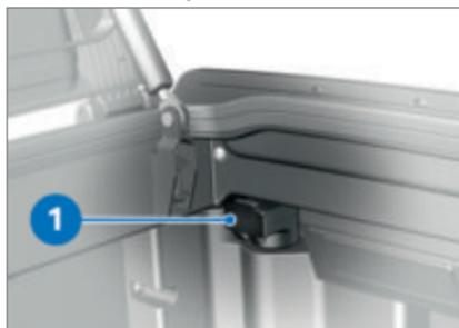
Der USB-Ladeanschluss befindet sich im Topcase (☞ 264). Es handelt sich um einen 5 V USB-Ladeanschluss **1**, der maximal 3 A Ladestrom (Ladeleistung maximal 15 W) zur Verfügung stellt.
