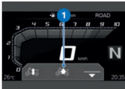
Die Fahrhöhe kann in zwei Stufen **1** eingestellt werden.
