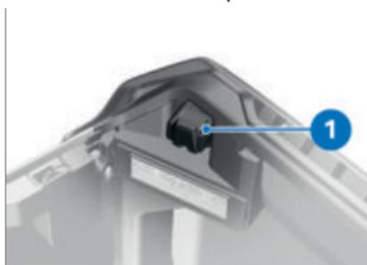
Der USB-Ladeanschluss befindet sich im Topcase (☞ 270). Es handelt sich um einen 5 V USB-Ladeanschluss **1**, der maximal 3 A Ladestrom (Ladeleistung maximal 15 W) zur Verfügung stellt.
