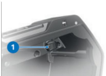
Der USB-Ladeanschluss befindet sich im linken Koffer (☞ 254).
