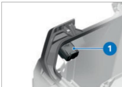
Der USB-Ladeanschluss befindet sich im linken Koffer (☞ 259).
