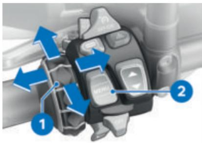
Die Bedienung des Navigationssystems erfolgt über den Multi-Controller **1** und die Wipptaste MENU **2**.
