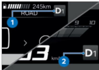
Der Indikator für den automatisierten Modus **D** und der aktuelle Gang wird in der Statuszeile **1** oder in der Ansicht Pure Ride **2** angezeigt.
