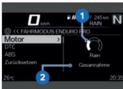
Das System **Motor** ist ausgewählt. Die aktuelle Einstellung wird als Diagramm **1** mit Erklärungen zum System **2** angezeigt.
