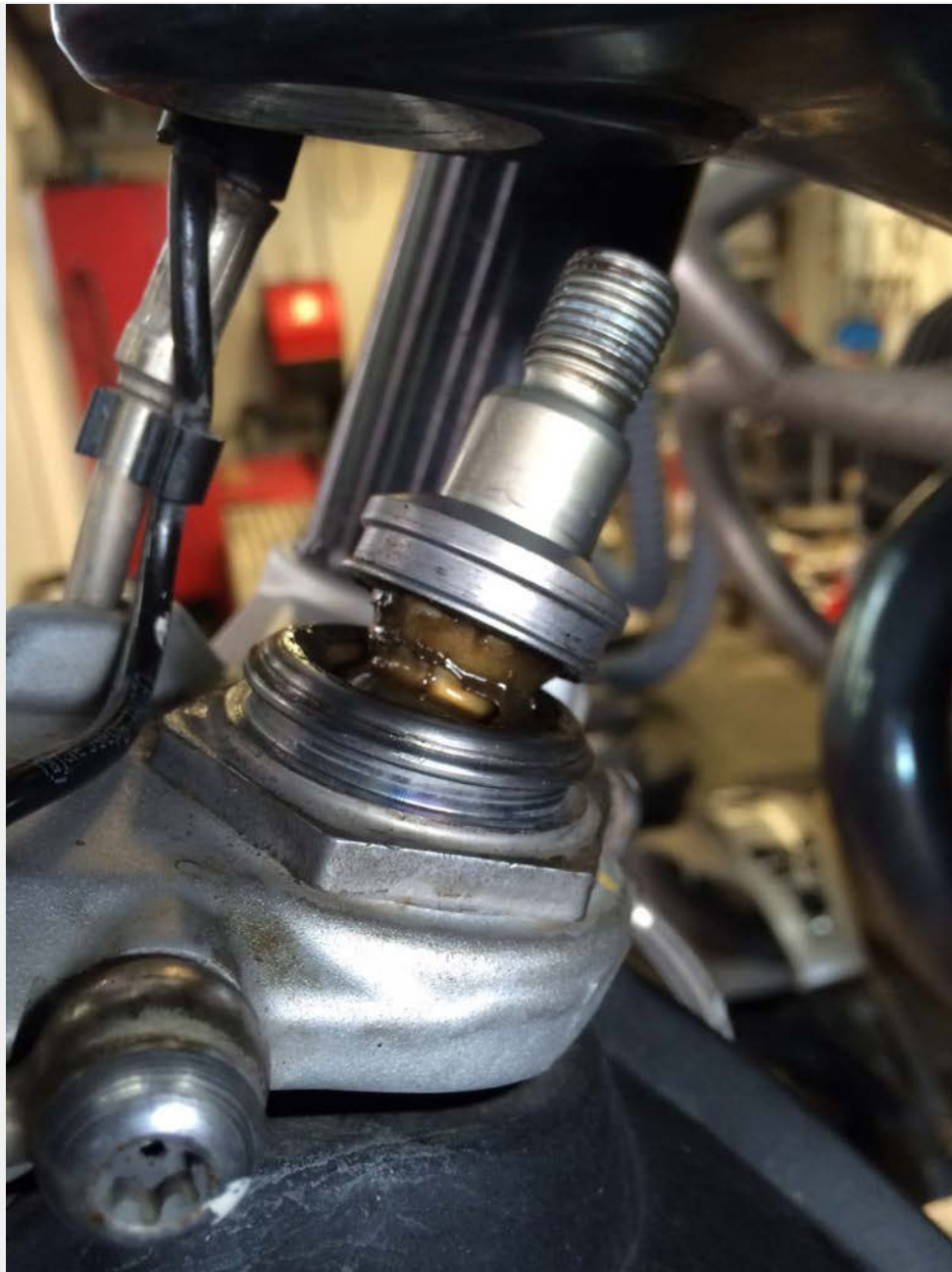
Gelenkgummi entfernen an der BMW Gabel
