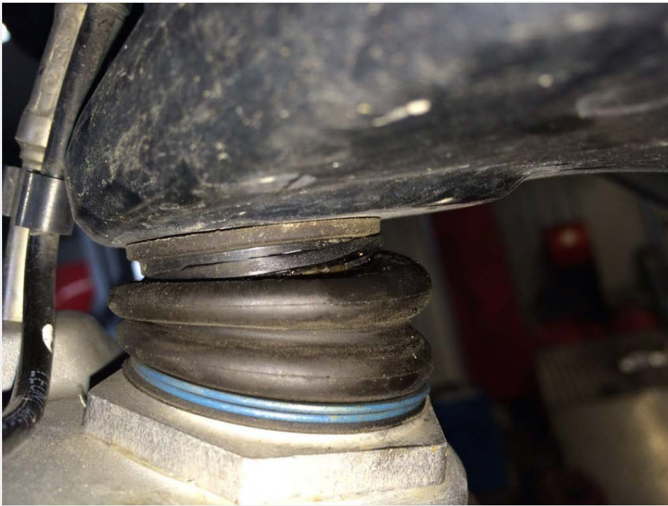
Reparatur des Kugelgelenkes mit neuem Gelenkgummi
