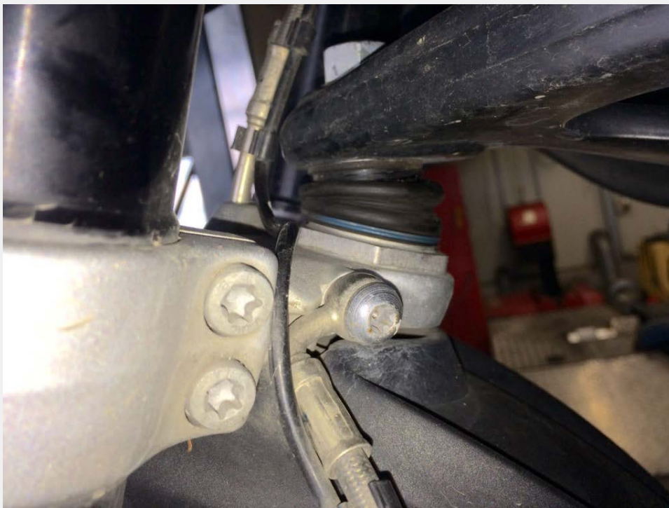
Smartrepair mit einer neuen Manschette am Kugelgelenk des Telelevers der BMW Gabel
