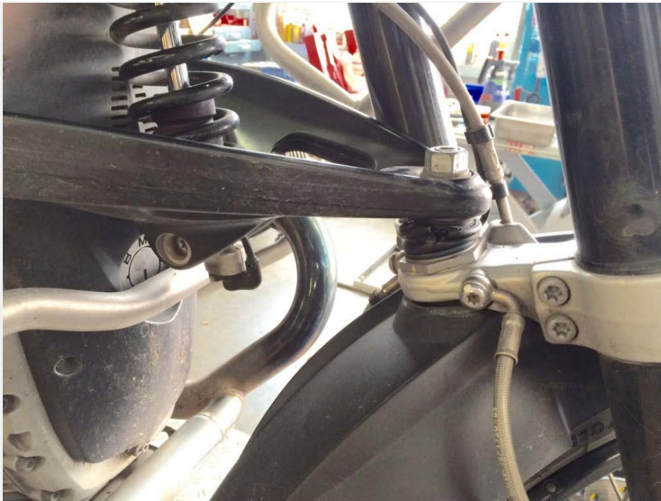
Kugelgelenk mit defektem Gelenkgummi BMW Telelever
