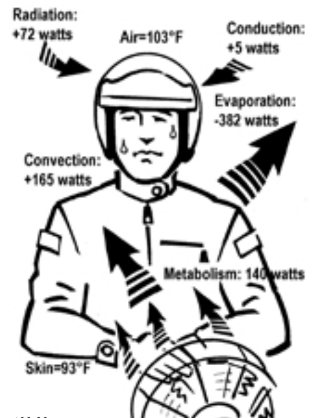
Abbildung Wärmebilanz beim Tragen eines belüfteten, winddichten Anzugs mit einer Lufttemperatur von 103°F Erforderliche Verdunstung: 19 oz. pro Stunde
