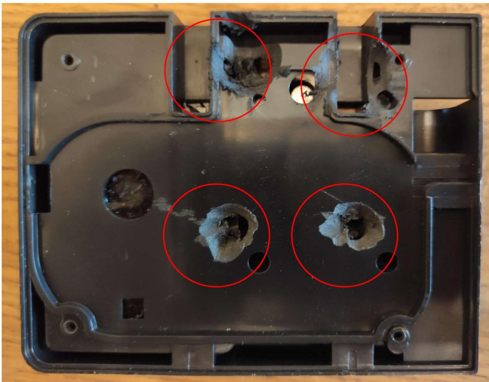
**Kunststoff entfernen und Leiterbahn ankratzen**
