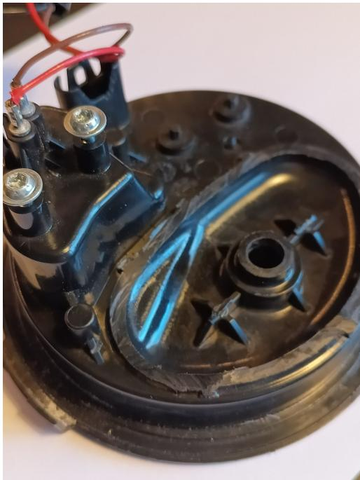
Am Deckel wurden das Filtergehäuse und die Tülle – wie im Bild zu sehen – entfernt. Das vorhandene 6 mm Bohrloch wurde anschließend auf 10 mm aufgeweitet.
