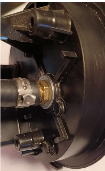
Zwischen Benzinpumpe und Deckel unbedingt einen intankfähigen Benzinschlauch verwenden, da dieser ständig im Benzin liegt!
