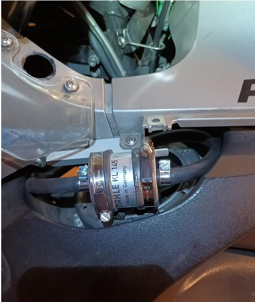
Dann habe ich den Benzinschlauch mit Klemmschellen an der Schnellkupplung und am Kunststoff-Benzinrohr gesichert. Den Benzinflter habe ich mit Schraubschellen montiert, um den Austausch zu erleichtern.
