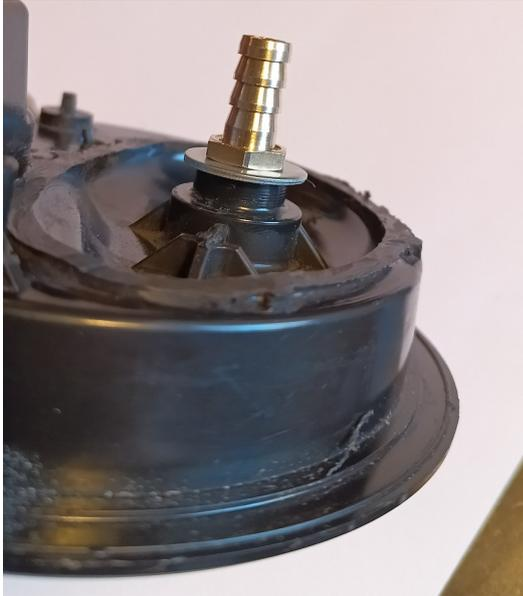
Unterlegscheiben verwenden, um die Biegebelastung durch den Benzinschlauch zu verteilen, und die Mutter mit blauem Loctite sichern.
