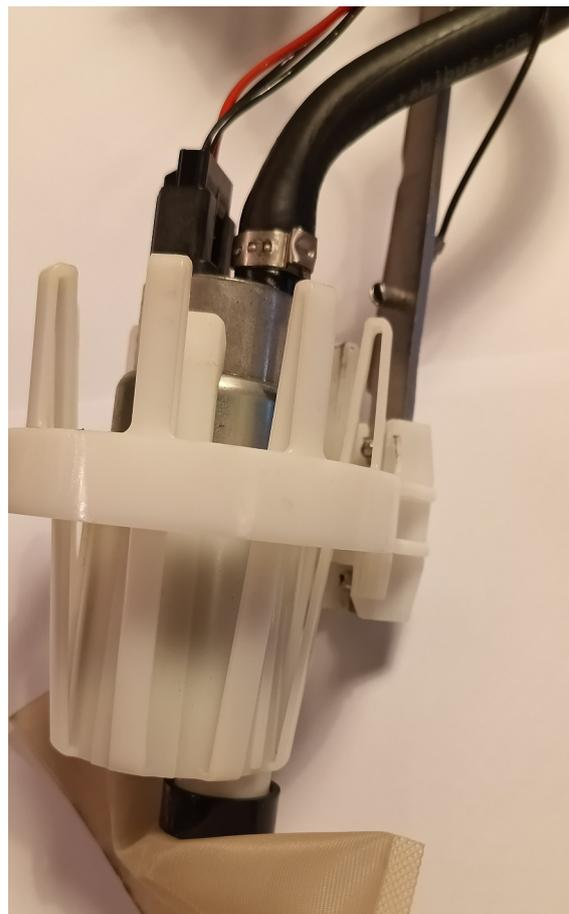
...Auch die Pumpe wurde mit 4×9 mm Blindnieten montiert, und der Benzinschlauch mit einer Edelstahlschelle gesichert.
