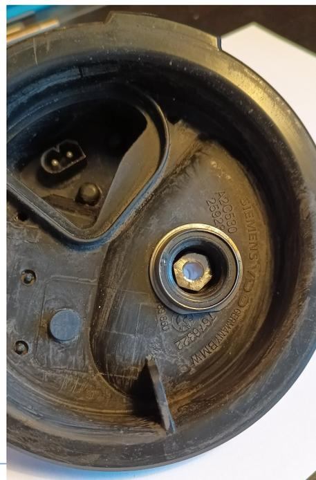
Danach die Schlauchtülle einsetzen. Ich habe vorsichtshalber etwas Zylinderkopfdichtpaste an der Unterseite aufgetragen, damit an dieser Stelle kein Benzin austreten kann.
